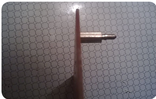
وصل شدن اسپیسر به PCB
