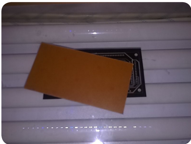
نمایی از فیبر مسی به همراه نگاتیو طرح PCB
